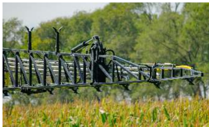
Caños conductores de acero inoxidable.
