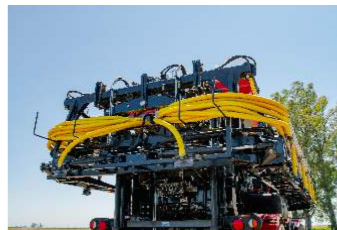
2 dosificadores de acero inoxidable con 3 juegos de rodillos dosificadores y accionamiento electro-hidráulico.
