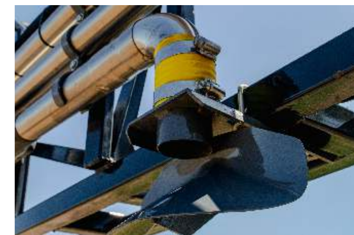
Picos Difusores: hasta 18 picos difusores de acero inoxidable marca ALTINA, para distribución de productos sólidos en cobertura total.
