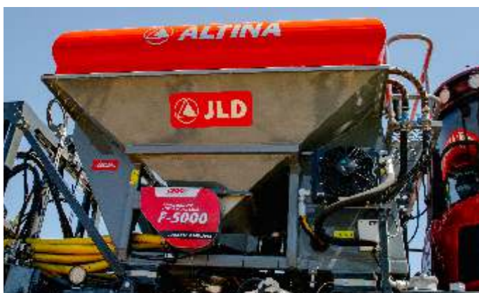
Tolva de acero inoxidable. Presurizada con removedor y criba anti-terron. Con divisor de caudal de sólidos para mejor distribución del material dentro de la tolva. Evita derrames fuera de la misma.
