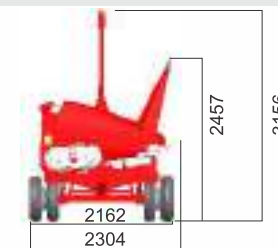
En cabezales de 14 a 18: Carro de transporte con doble eje en tándem trasero y avant tren.
